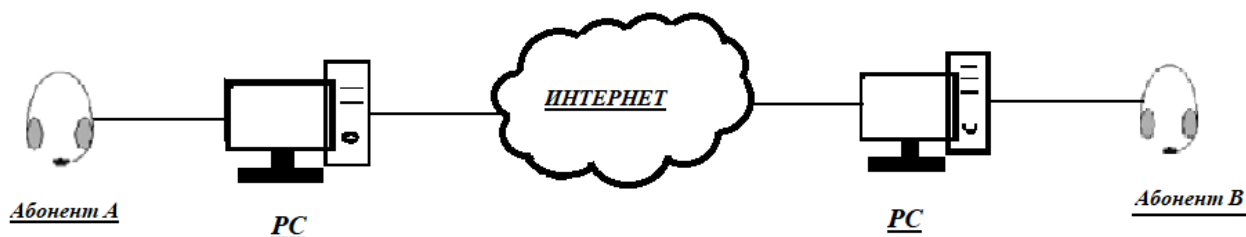
Рис. 1. Структурна схема організації телефонного зв'язку через Інтернет
