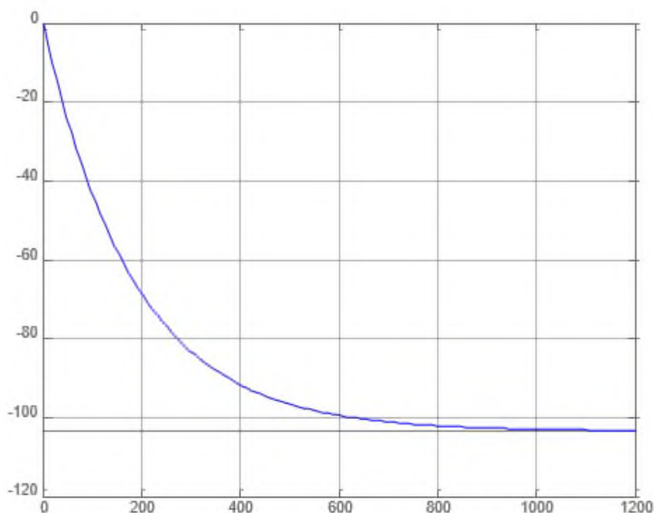
Рис. 4. Перехідна характеристика холодильника за каналом «витрата води – температура охолодженої нітрози».
