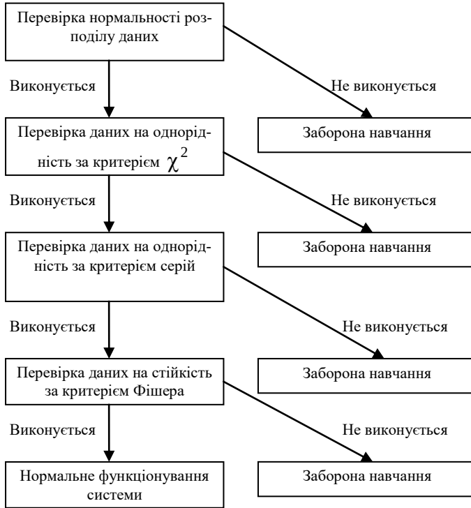
Рисунок 2.6 – Ієрархічна структура алгоритму оцінки статистичних стійкості та однорідності навчальної вибірки
