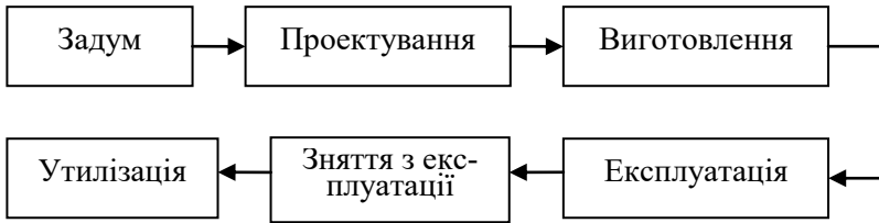
Рисунок 1.3 – Схема етапів життєвого циклу системи
